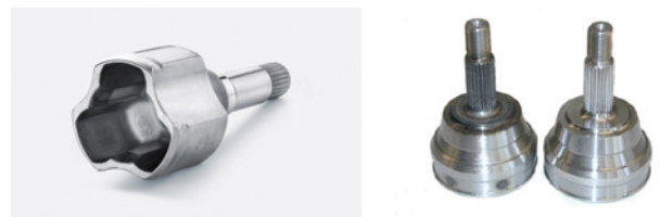
Abb. 2: Tulip/Tripode (links) und Antriebsglocken/CV-Gelenke (rechts)
