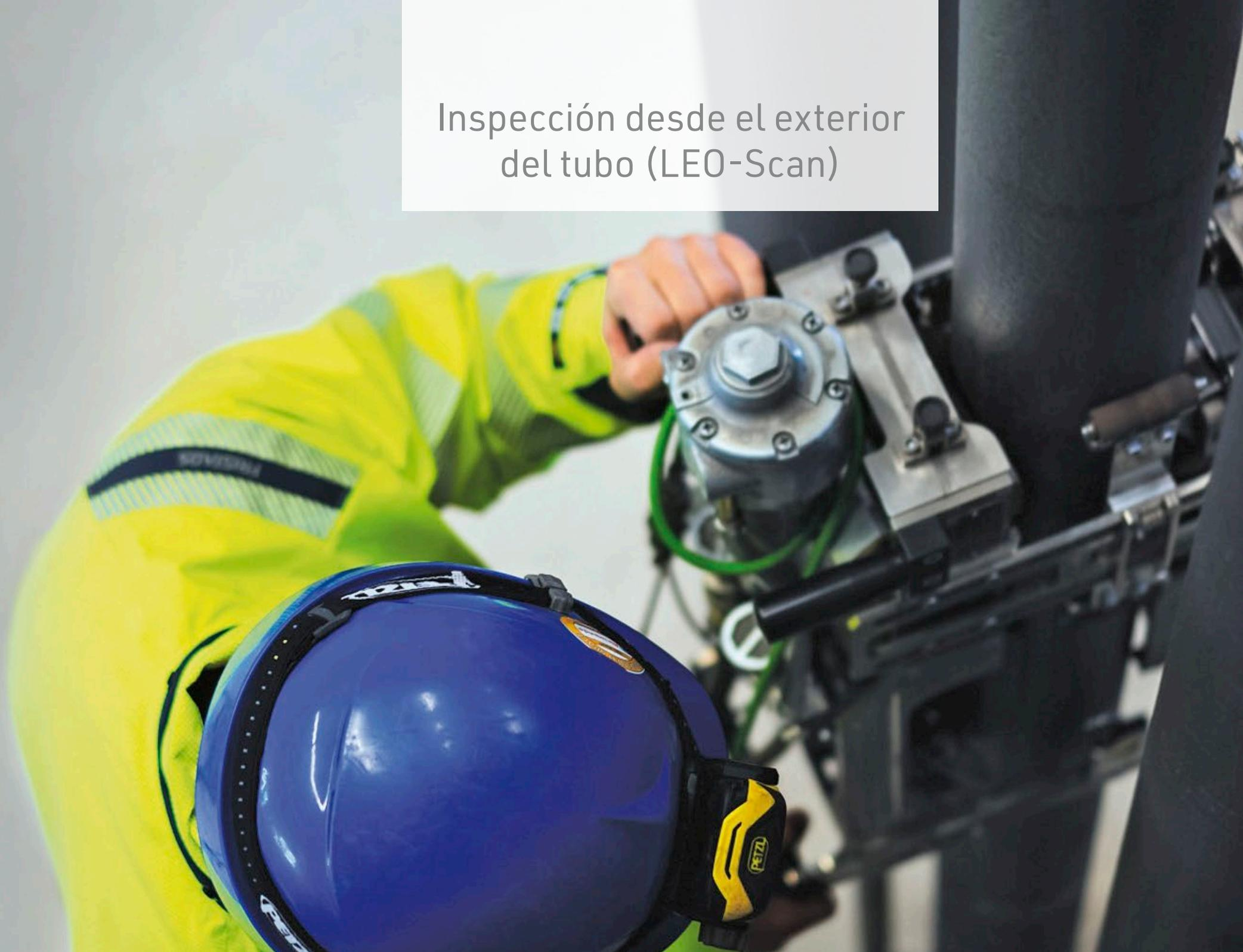
Con el fin de inspeccionar los tubos catalíticos de fundición centrifugada utilizados en los reformadores de metano con vapor, FOERSTER ha desarrollado, construido y patentado el sistema 'LEO-Scan', una inspección realizada desde el exterior de los tubos, utilizando la técnica de corriente eddy y láser.
