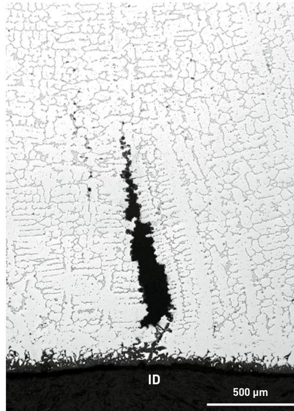
Figura 7: Microfotografía ampliada de fisura por fluencia
