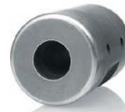
Zum Einrichten von Prüfsystemen mit **Rotiersonden** zur Rissprüfung werden Standards mit Bohrungen aus dem zu prüfenden Material verwendet. Die Standards werden in zwei Varianten angeboten:
