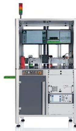
*Band-Prüfzelle „Mercur“ der HDS-Group GmbH zur Geometrie- & Gefügeprüfung an kopflosen Verbindungselementen wie bspw. Stiften und Hülsen. Mit integriertem MAGNATEST D von FOERSTER.*
